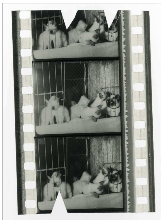
13. kép: Az 1 órán keresztül csapvízzel folyadékfázisban kezelt minta (800 dpi)
