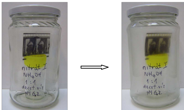
7. kép: A kezelés során telített gőztér alakul ki, a páralecsapódás megfigyelhető az edény falán
