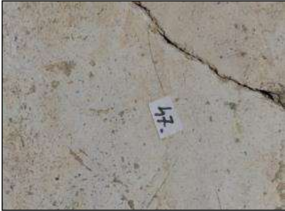
77. kép. Besimított felület, a simítóeszköz alatt gördülő szemcsék okozta karcokkal ( Iseum korai falfestményei, Isis papnőt ábrázoló festmény töredéke. Savaria . Foto: H.E.)
