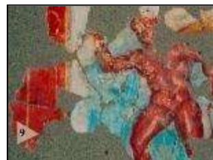
154/c. kép. PLM (obj. 10x) átmenő fény, részben keresztezett polarizátor–analizátor állás. Beágyazó anyag n=1,537 . (Foto: G.É.)
