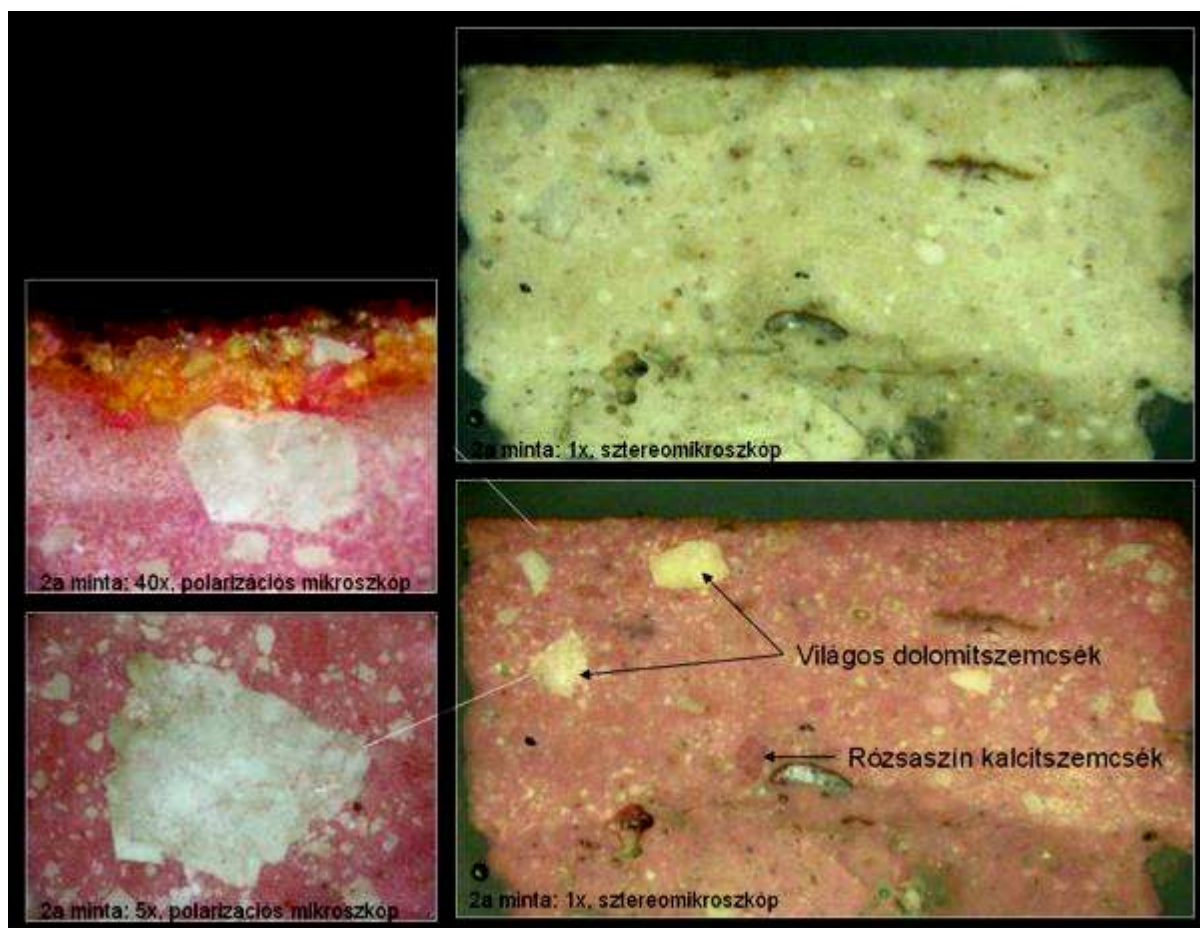
76. kép. Dolomit tartalmú intonaco (Palotaépület, Szabadbattyán. Pecze–Vali 2009)
