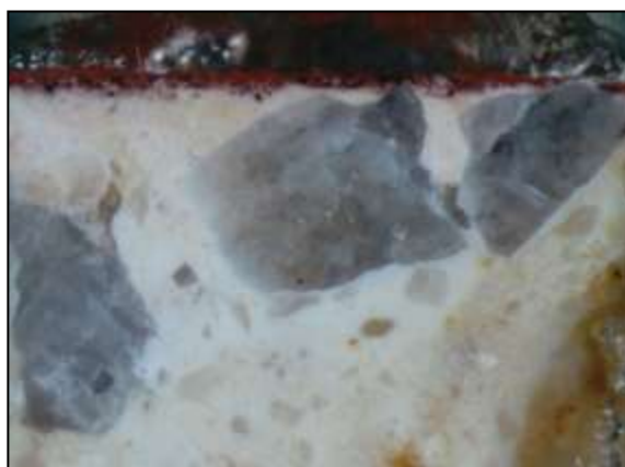
72. kép. Kalcit szemcsék az intonacóban („Szily János utcai falfestmény”, Savaria . OM Galambos. Restaurálási dokumentáció, Kurovsky 2006)
