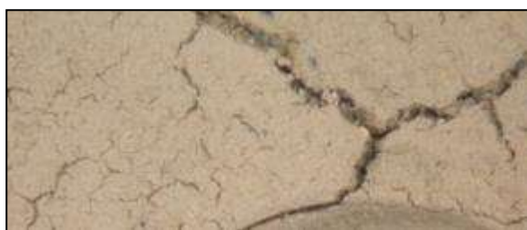
17/e. kép. Az épített szerkezet felületét kiegyenlítő elsőként felhordott vakolatrétegből származó minta savban nem oldódó maradéka. Sztereo mikroszkópos felvétel (Foto: H.E.)
