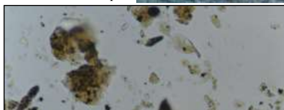
194/c. kép. PLM (obj. 10x) átmenő fény, részben keresztezett polarizátor–analizátor állás. Beágyazó anyag n=1,537. (Foto: G.É.)
