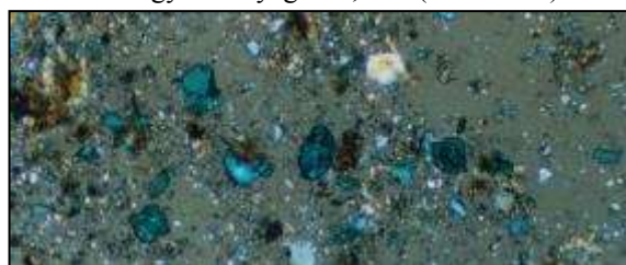
185/e. kép. PLM (obj. 10x) átmenő fény, részben keresztezett polarizátor–analizátor állás. Beágyazó anyag n=1,537 . (Foto: G.É.)
