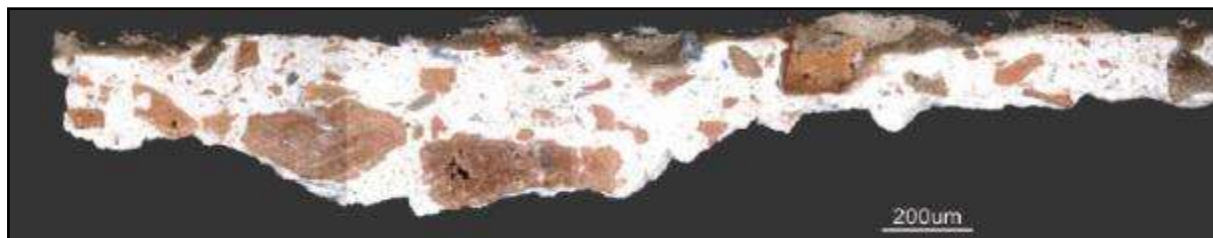
13. kép. Téglatörmelék mintakészítésének keresztmetszet csiszolata. (La Magdalena, in Alcalá de Henares/Madrid (OM, Guerra et al. 2014, fig.3.)
