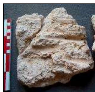
46. kép. Vesszőkből font könnyűszerkezetes mennyezet lenyomata („Szily János utcai” falfestmény, Savaria . Foto: K.Zs.)
