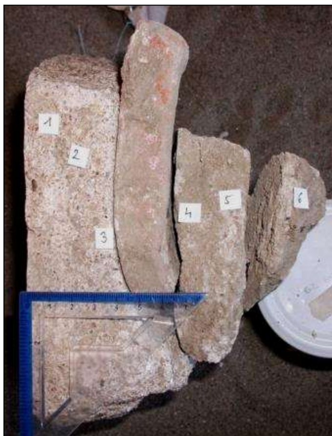
48/a. kép. Az egy réteg intonaco val együtt hét vakolatréteggel rendelkező töredék (Foto: H.E.–K.Zs.)
