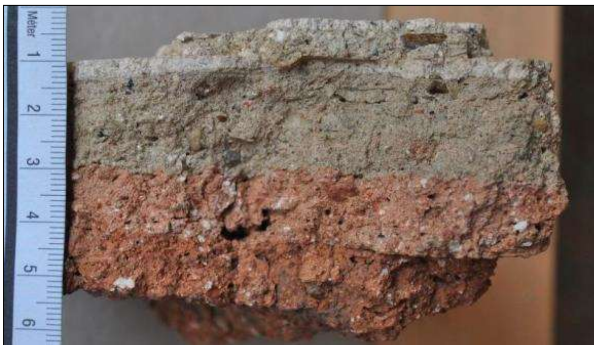
68. kép. Alsó két arriccio réteg töltőanyaga cserép vagy téglalőrlemény. (Szőny/Duna part – 1-es lelőhely. Str. 11. Leletmentés, 2014. Foto: H.E.)
