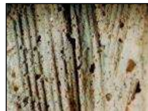
14. kép. Növényi szálas–anyag lenyomata a vakolatban. Sztereo mikroszkópos felvétel. (Gorsium, XL épület kis helyisége. Foto: G.É.)
