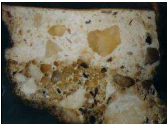
61. kép. Arriccio réteg folyami homok (K/Sz–Vt. I/1. Mennyezet, sárga sáv, Brigetio . (OM, kmcs, Galambos) Harsányi–Kurovsky 2004)
