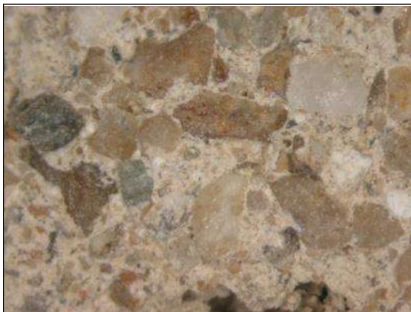
60/c. kép. Arriccio réteg folyami homok ( Iseum korai falfestménye (OM, Harsányi) Harsányi 2014)
