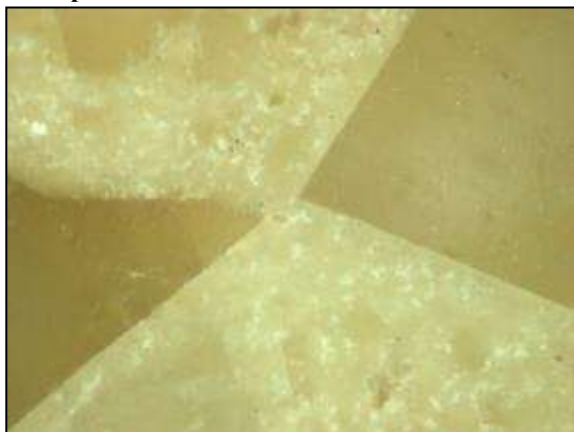
70/a. kép. Kalcit szemcsék az intonacóban („Füredőépület”, Aquincum . OM, kmcs, Papp 2012, 67, 24. kép)
