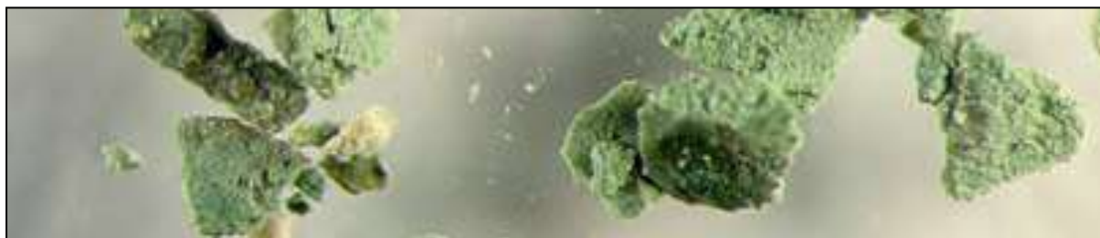
122. kép. Zöldföld szemcsék falfestményből PLM. (Strasbourg, Franciaország. Pagès-Camagna–Laval 2012, 132 Fig .4.)
