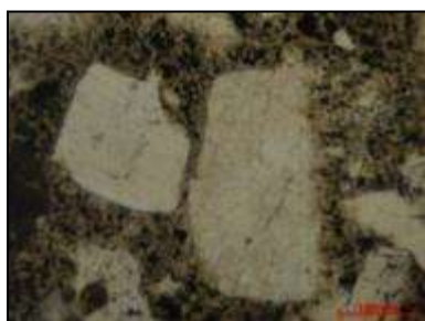
59/b. kép. Plagioklász és kvarcit (PLM 10x, átmenő fény, Erdei 2013, 48, 19. kép)
