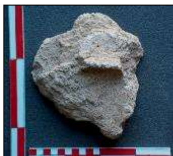
44. kép. Fűtéstégglák legömbölyített éleinek illesztése mentén a mélyedésbe beült habarcs megmaradt részlete. („Szily János utcai” falfestmény, Savaria . Foto: K.Zs.)
