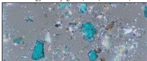
179/e. kép. PLM (obj. 10x) átmenő fény, részben keresztezett polarizátor–analizátor állás. Beágyazó anyag n=1,537. (Foto: G.É.)
