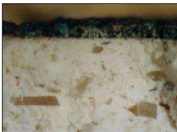
74. kép. Kalcit szemcsék az intonacóban (K/Sz–Vt I/1. mennyezet. OM, Galambos)
