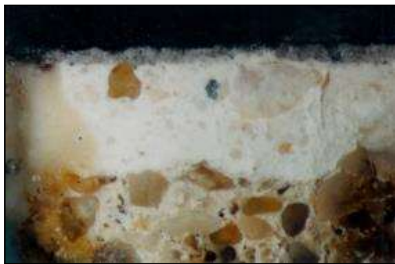
63. kép. Arriccio réteg folyami homok. (XL épület kis helyiségének oldalfala, Gorsium (OM, Galambos) Harsányi–Kurovsky 2004a)
