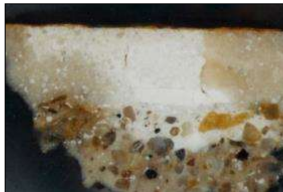
64. kép. Arriccio réteg folyami homok ( XCLV épület „páncélos alakot ábrázoló falfestmény” oldalfal, Gorsium (OM, Galambos) Harsányi–Kurovsky 2004b)
