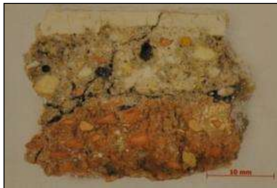
67. kép. A képen látható alsó arriccio réteg töltőanyaga túlnyomó részt cserép vagy téglalőrlemény, kisebb mennyiségben kvarc és mészkőszemcsékből áll. („San Marco utcai” falfestménylelet, Aquincum , katonaváros, (OM, kmc, Erdei) Erdei 2013, 34, 6. kép)
