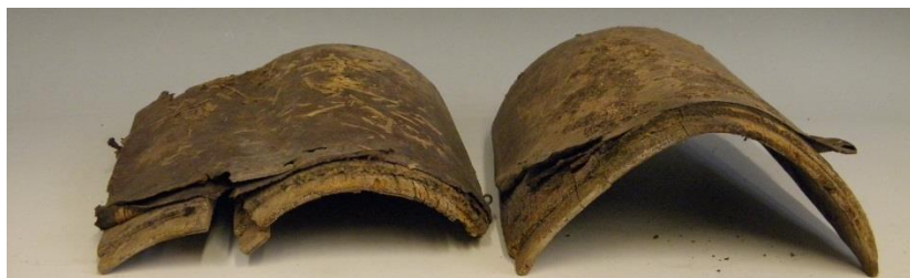
15. kép Kupatok (Etk 17) famagjának vetemedése (kuppatest)
