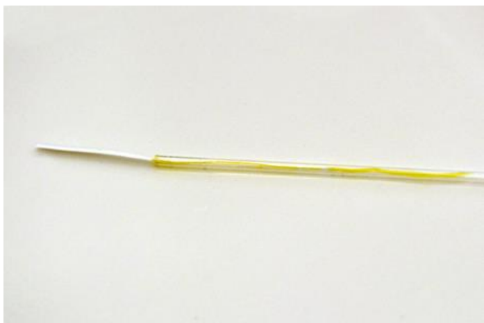
10. kép: A szűrőpapír végét a reagensbe mártjuk, majd visszaillesztjük a kapillárisba
