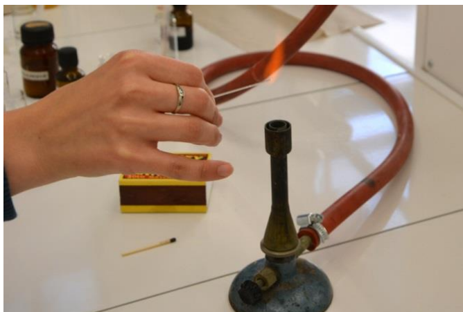
23. kép: Gázláng felett lezárjuk a cső végét
