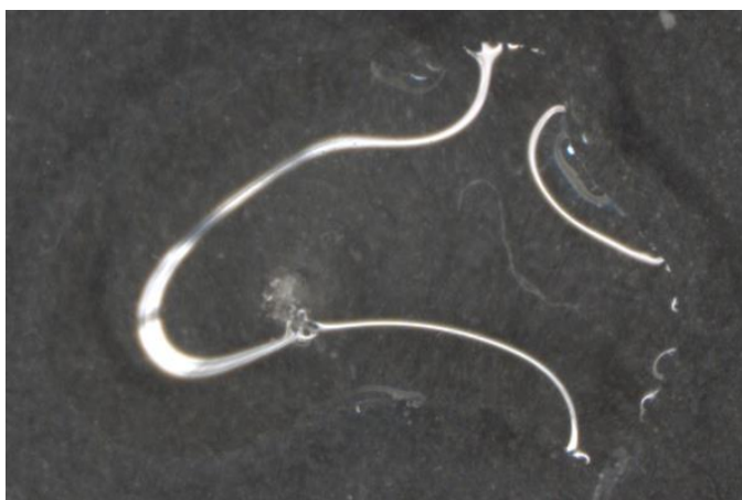
235. kép: A darabminta savas megcseppentés hatására elpezsgett
