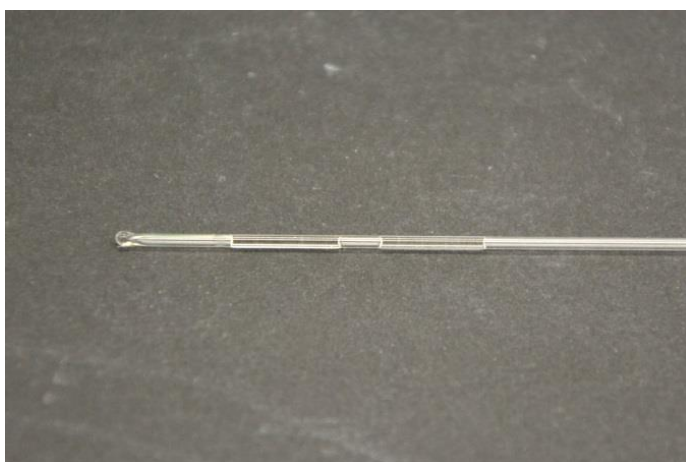
32. kép: A cső végét gázláng felett lezárjuk
