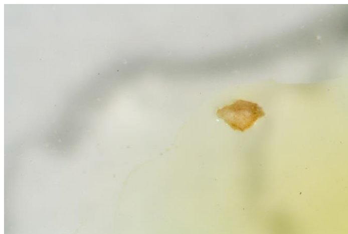
144. kép: Az alapozó minta a kálium-jodid oldatban nem sötétedett el
