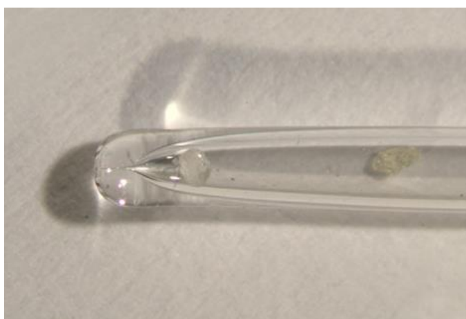
7. kép: A mintát lerázzuk a kapilláris összezárt végébe
