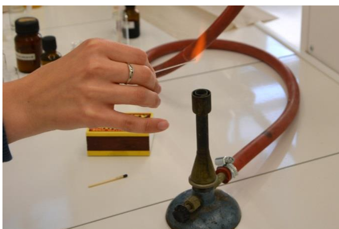
6. kép: A kémcső végét gázláng felett összeolvasztjuk - bezárjuk
