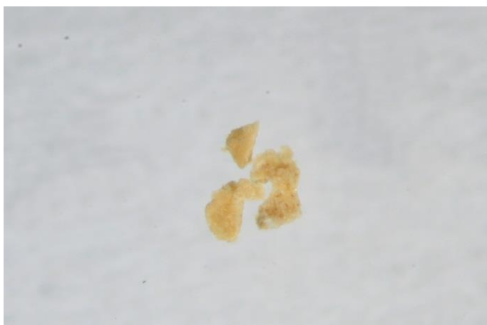
128. kép: Alapozó darabok a teszthez a 4-es mintából
