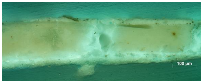
71. kép: A minta UV (balra) és BV (jobbra) gerjesztésben, 20x-os objektív
