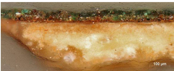
61. kép: A minta polarizációs mikroszkópos képe, normál megvilágítás, 20x-os objektív
