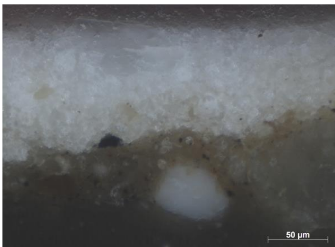
232. kép: A minta polarizációs mikroszkópos képe, normál megvilágítás, 50x-es objektív
