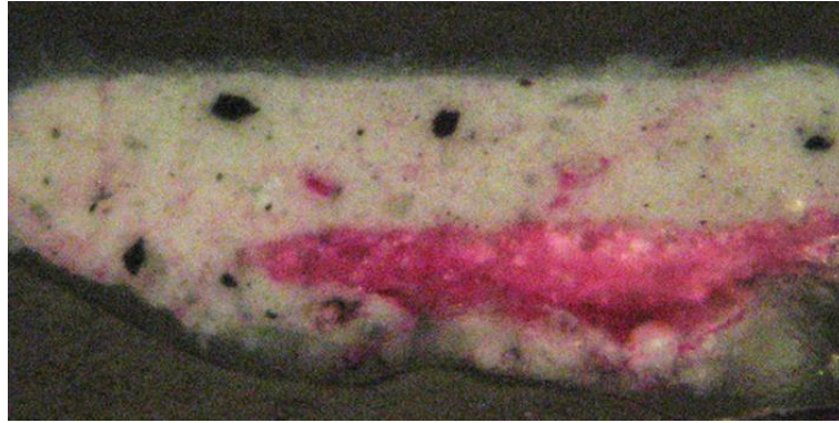
5. kép: A festékrétegen a polírozás okozta karcolásokba beülő reagens
