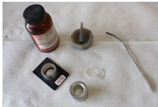
36. kép: Kálium-bromid pasztillák, a készítéséhez szükséges eszközökkel
