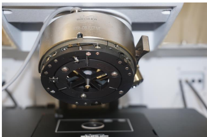
40. kép: ATR objektív fotója (balra) és sematikus rajza (jobbra)
