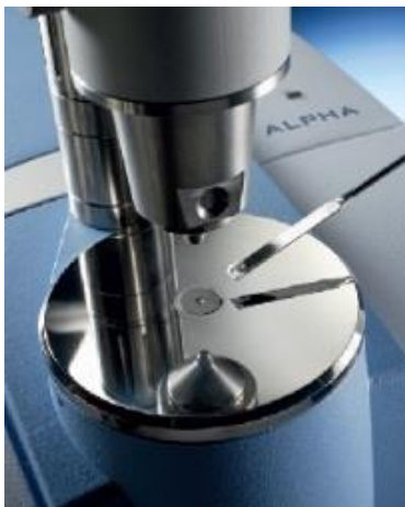
39. kép: Beágyazatlan kaparék (por) minta mérése
