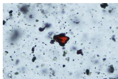
101. kép. C5 minta, cinóber szemcsék, (PLM. 20 x obj.)
