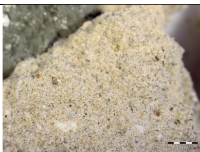
A vakolatminta törésfelülete (sztereo-mikroszkóp, 0,8 x obj.)
