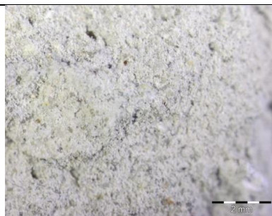
A vakolatminta törésfelülete (sztereó-mikroszkóp, 0,8 x obj.)
