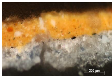
106. kép. Szürkés-kék aláfestésen sárga festékréteg, keresztmetszet- csiszolat (C9), (PLM. 20 x obj.)
