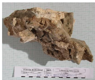
149. kép. Folyékony üveggel összetapasztott homokkő darabok
