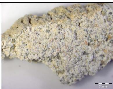
A habarcsminta törésfelülete (sztereó-mikroszkóp, 0,8 x obj.)
