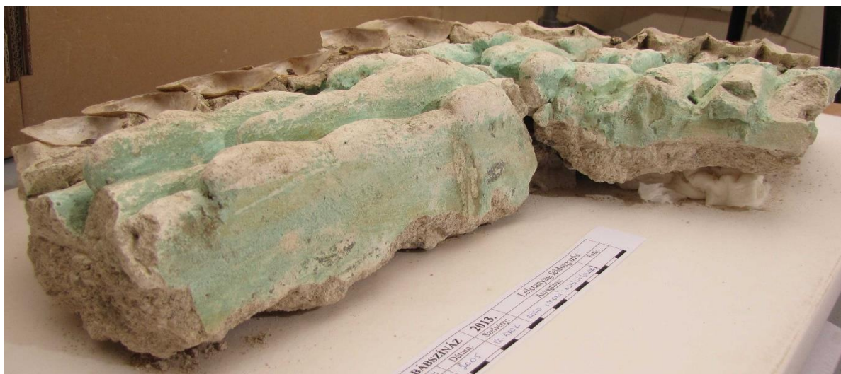
144. kép. Zöld festésű, kagylósorral díszített, mohás sziklát megjelenítő ajtókeretezés darabja. A fülső béléttében a stukkó anyagát csak vékony rétegben vitték fel
