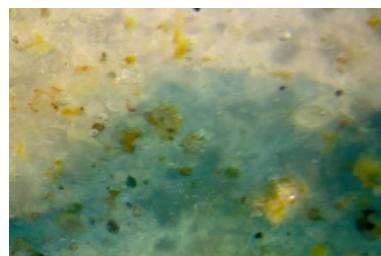
110. kép. C9 minta, pozitív vasteszt, (szm., 5,6 x obj.)
