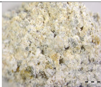
A habarcsminta frissen tört felülete (sztereó-mikroszkóp, 0,8 x obj.)
