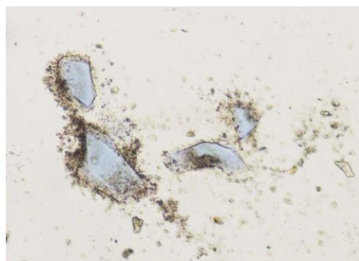
212. kép. Szemcsepreparátum, PLM. 20 x obj., smalte szemcsék
