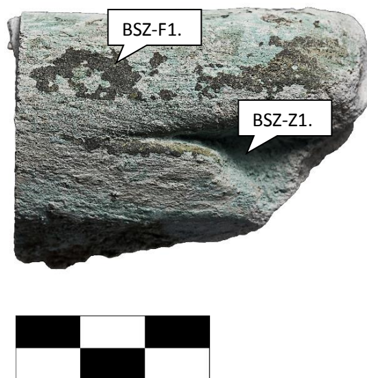
182. kép. Zöld mohás sziklát imitáló stukkó töredékek a mintavételi helyekkel
