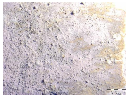
198. kép. Rűcskők a festett felületen, sűrű felvétel, szm., 0,8 obj.
