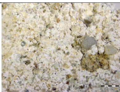
A vakolatminta törésfelülete (sztereo-mikroszkóp, 0,8 x obj.)
