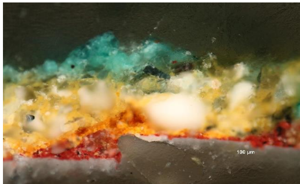
127. kép. C10 minta, keresztmetszet-csiszolat, a zöld festékrétegben kék smalte szemcsék is találhatóak (PLM. 20 x obj.)
