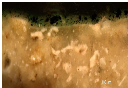
185. kép. (BSZ-Z1.), kén-hidrogén gőz hatására a zöld szemcsék elfekedtek, PLM. 10 x obj.
