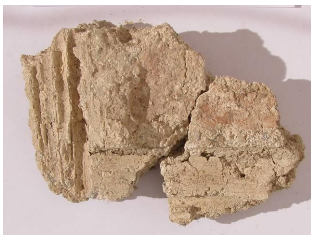
174. kép. Téglalenyomat, vízszintes gerenda és nádazás nyoma vakolattöredéken, normál felvétel, szerkezeti rajz
