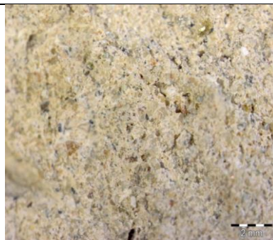
A vakolatminta frissen tört felülete (sztereó-mikroszkóp, 0,8 x obj.)
