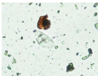
216. kép. Szemcsepreparátum, PLM. 20 x obj., barna okker szemcsék
