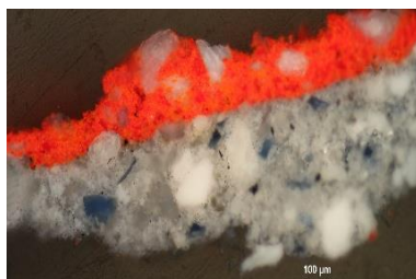
97. kép. Szürkéskék aláfestésen egyenetlen vastagságú (általában 50-100 µm) élénk vörös festékréteg, keresztmetszet-csiszolat (C5), (PLM. 20 x obj.)
